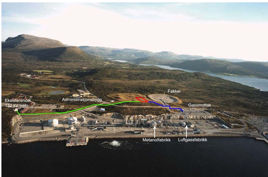
Figur 6: Oversiktsfoto Tjeldbergodden. Aktuell tomt for et midlertidig mobil kraftproduksjonsanlegg er vist med rød avgrensing. Planlagt kraftledningstrasé er vist med grønn strek og mulig trasé for tilknytningsrør for naturgass er vist med blå strek. Foto: Statoil
