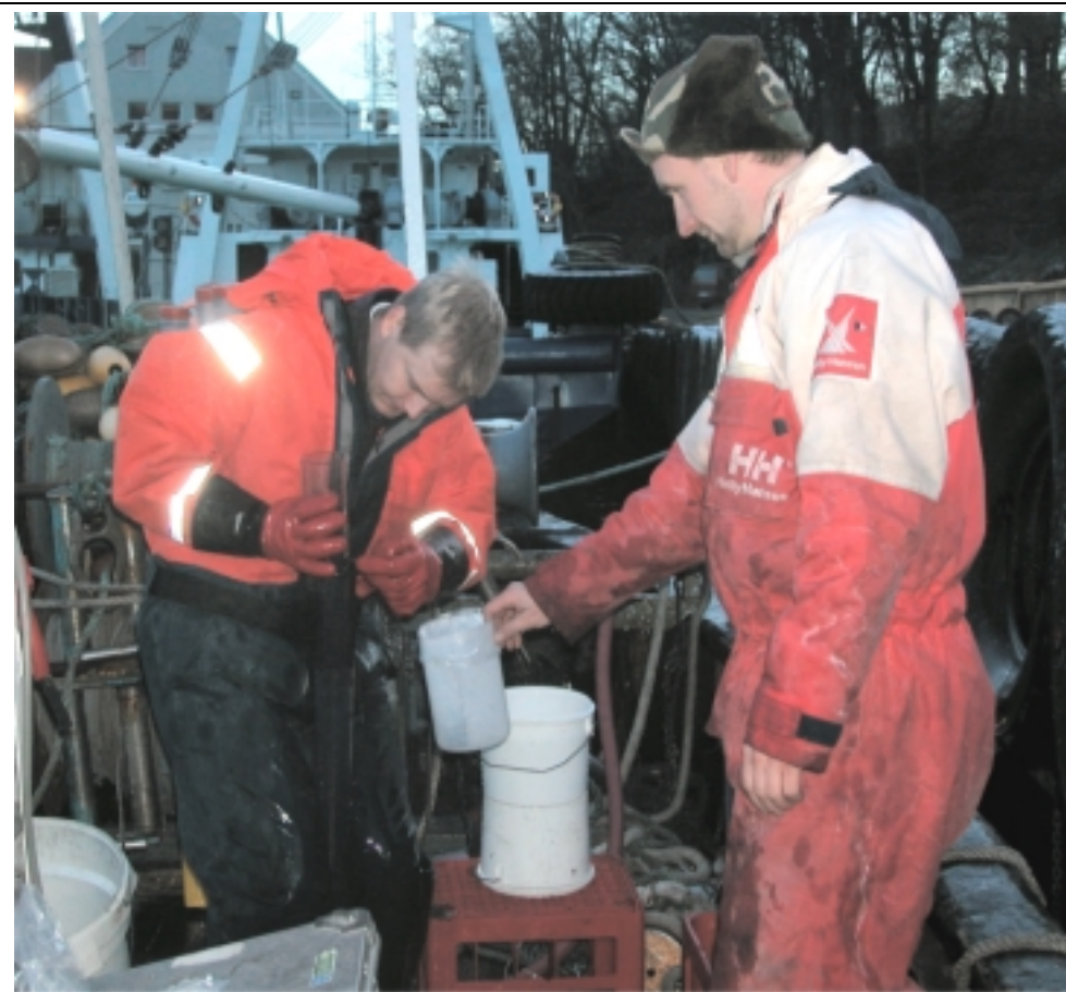
Kapping av kjerner med ”kjernekapprer”
