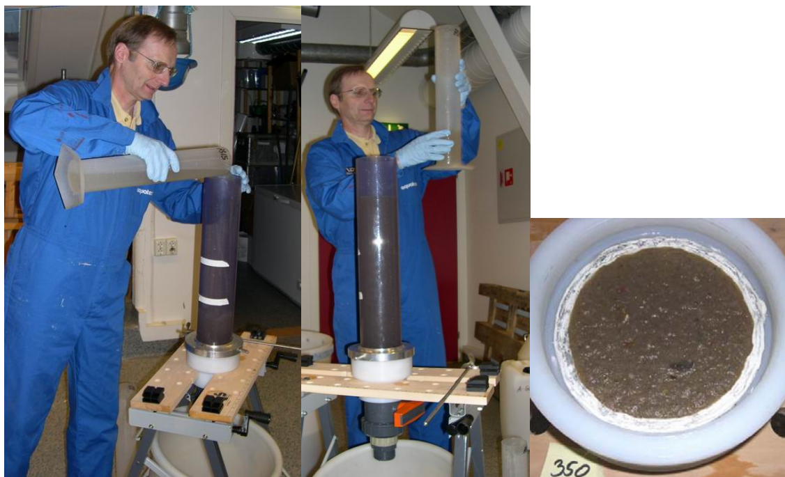
Figur 3. Bilder som viser oppfylling av testapparatet med avløpsvann, samt eksempel på en filtermatte etablert på en silduk med 350 my lysåpning.
