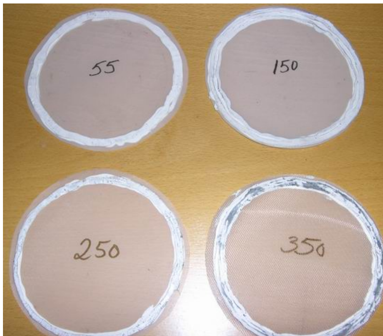
Figur 2. Bilder av noen av sildukene brukt i forsøkene. Tallene angir lysåpning i mikron (my).
