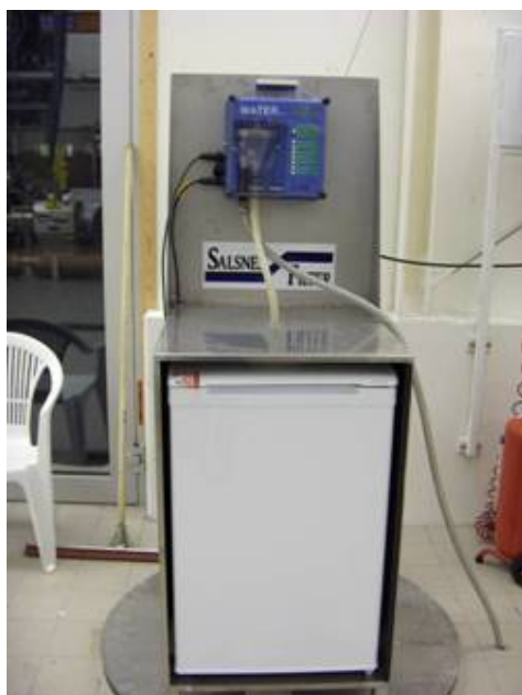
Fig. 1. Prøvetaker av typen PSW 2000 som ble brukt i Tromsø kommune.
