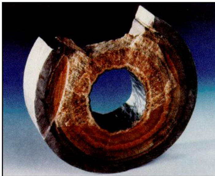
Figur 2.1: Foto av snitt av produksjonsrør delvis gjengrodd med avleiring.
