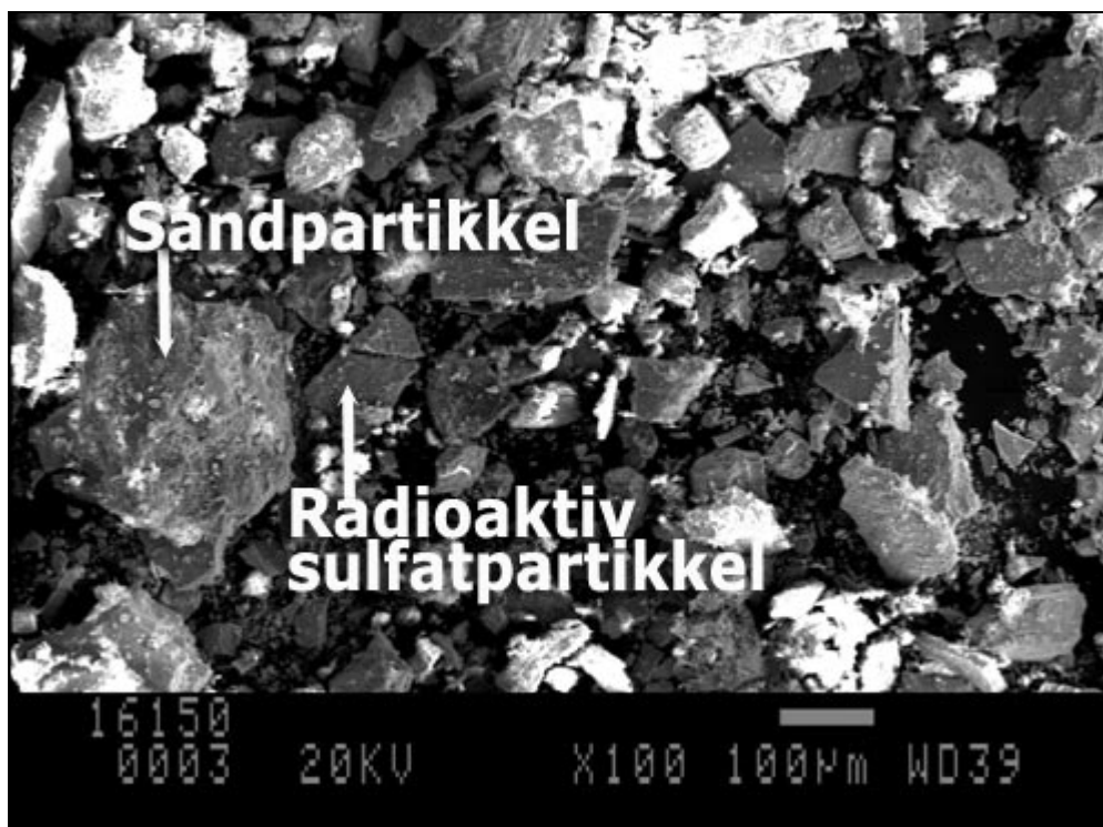
Figur 2.2: Bilde av typisk LRA tatt med Scanning elektronmikroskop. Ved bruk av røntgendispersiv analyse er det mulig å bestemme innholdet av ulike grunnstoff i hver enkelt partikkel og derigjennom fastslå partikkelens kjemiske sammensetning for eksempel for \text{BaSO}_4 -bariumsulfat.
