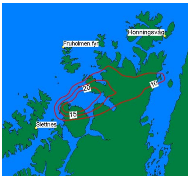
Figur 3: Sommert tørr- og våtavsetning av nitrogen for utslipp fra Hammerfest LNG i mg N / m 2 per år/1/
