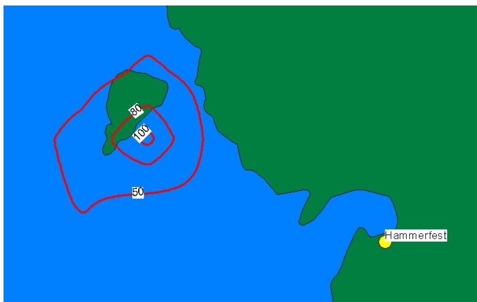
Figur 2: Maksimal timemiddelkonsentrasjon (µg/m 3 ) av NO 2 fra utslipp fra Hammerfest LNG/1/.
