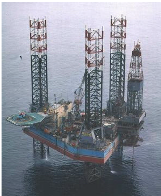
Figur 2. Mærsk Guardian oppjekkbar borerigg
