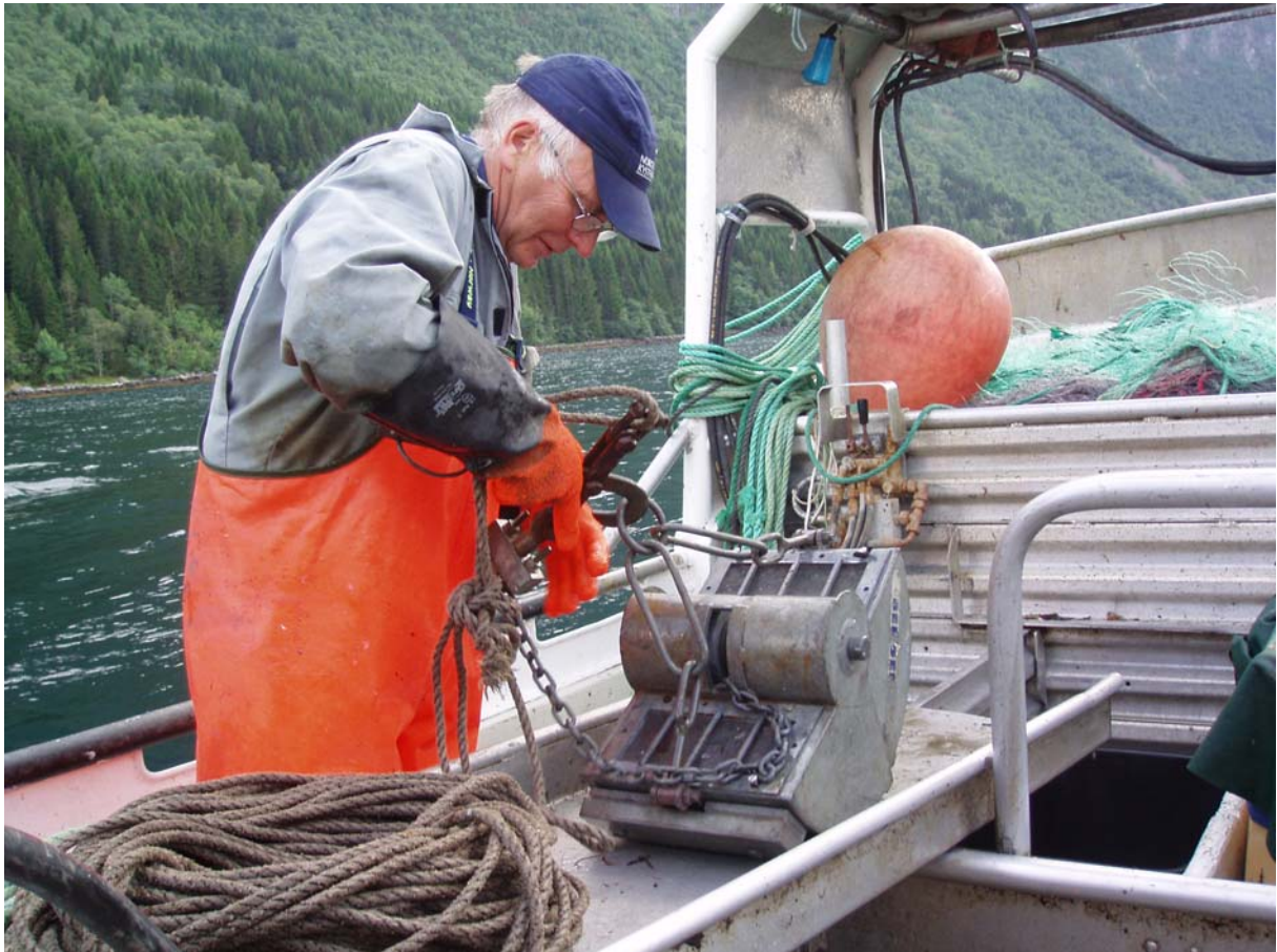
Figur 2. Fisker Kjell Arne Sundgot om bord i Straumsund klargjør grabben for innsamling av sediment.
