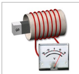
Figur: Man kan generere sin egen elektriske strøm ved å bevege en magnet i forhold til en spole!
