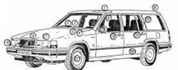
Figur: Eksempler på mange av stedene hvor det finnes permanente magneter i en vanlig moderne bil.
