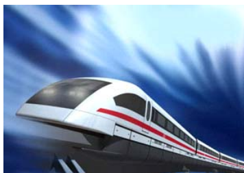
Figur: Et svevetog akselereres ved at elektromagneter skrus av og på i skinnene og på selve toget.
