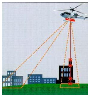
Figur: Slik skjer en større time-of-flight-laser-scanning.
