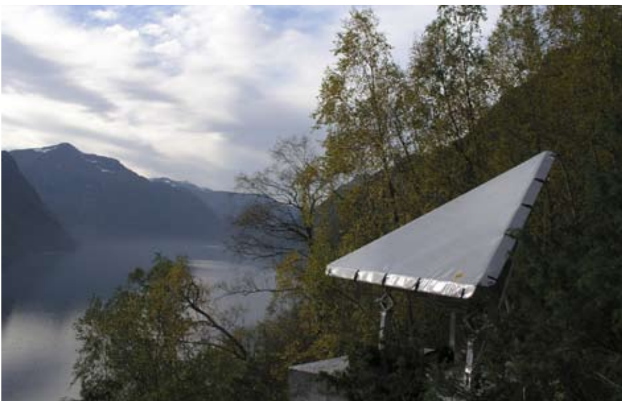
Radarreflektorer kan gjøre radaren mer pålitelig i områder med mye vegetasjon. Foto: Tom Rune Lauknes
