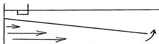
Sedimenteringsbasseng med falsk bunn.
