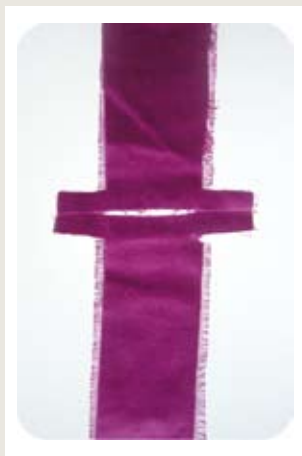
5. Test av sømstyrke: Sømmen har røket
