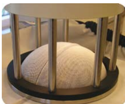
2. Vi har også mulighet til å teste hvor godt sømmene holder vann
